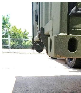
REAR ROLLERS (SIDE VIEW) TUCKED INWARD BENEATH CONTAINER
